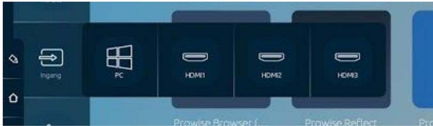
Diese Funktion im Prowise Central Menü ermöglicht es Ihnen, die Eingangsquelle zu ändern. So öffnen Sie z. B. das PC-Modul oder den HDMI1-Kanal.
