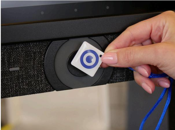
Der NFC-Sensor befindet sich direkt hinter dem Ein/Aus-Schalter in der Mitte des Bildschirms. Halten Sie die NFC-Karte vor die Steuerungstaste, um sich mithilfe der NFC-Technologie anzumelden. Die NFC-Karten sind als optionales Zubehör erhältlich.
